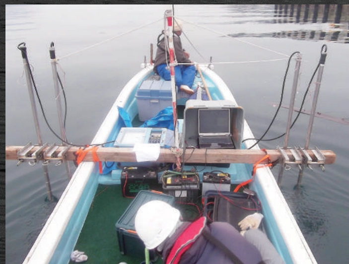
深浅測量 (シングルビーム方式、ナローマルチビーム方式)
