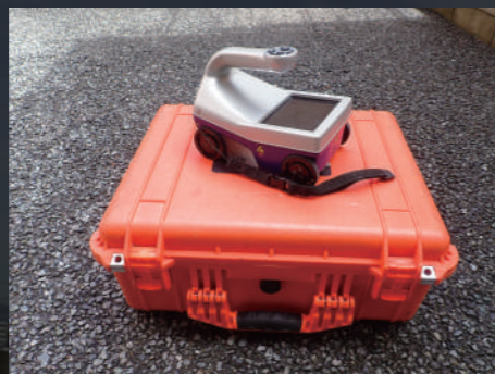
鉄筋探査機 SIR-EZ HR(GSSI)
